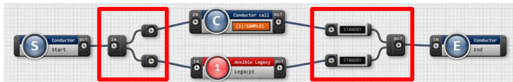
図 4.1- 5 Node 制約事項(正常例:Parallel branch)
